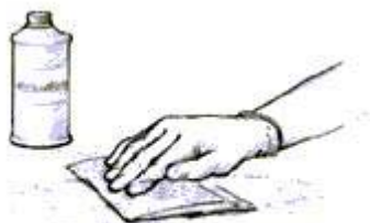
图6 为了移除所有的污染物，如有必要可使用溶剂清洁该表面。
